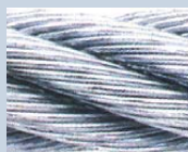
0160. INOX čelično uže, konstrukcije 7x19, materijal 1.44019
